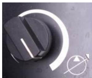
Controle de fluxo da bomba
