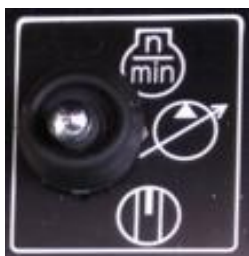
Chave seletora de controle da bomba
