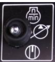
Chave seletora de controle da bomba
